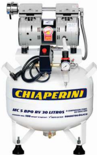
MC 5 BPO - 30L - 1HP - 4P 2 Cilindros Vertical 1 estágio - 120 lbf/pol 2 CÓD. 20630 - 127V CÓD. 20631 - 220V
