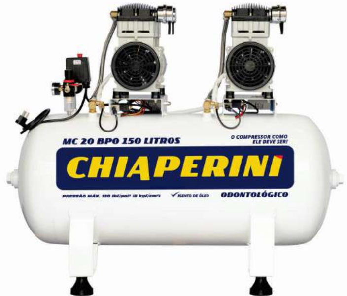
MC 20 BPO - 150L - 2x2HP - 4P 2x2 Cilindros Vertical 1 estágio - 120 lbf/pol 2 CÓD. 21235 - 220V
